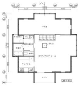
東京郊外の田園風景が広がる地域に建つ二世帯住宅である。1階に親世帯、1階の一部と2階に子世帯が住む構成である。極端に低予算だったため、様々な工夫を試みた。まず、平面を正方形とすることで、同じ床面積に対しての外壁の長さを最短とした。材料の使用量が少なくコストを抑えると同時に、外部と接する壁が少ないため熱負荷を低減することができる。構造的にも、正方形平面を基にした単純な架構とすることで、耐震性と低価格を両立させた。しかし、正方形平面では中心部が暗くなりがちな問題を解決するためにトップライトを設け、中心部の採光を確保した。さらに、その光が1階にまで届くように、2階床にトップライトと同位置に同サイズのガラス床を設置した。
